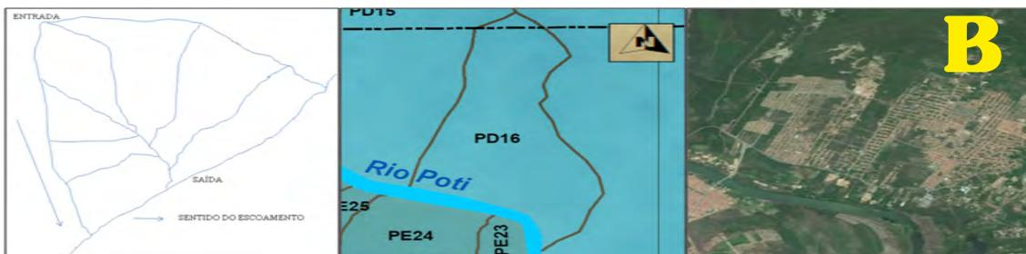
Modelo esquemático de sub-bacia hidrográfica com forma triangular tipologia B
