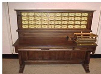
**Figura 7: Máquina de Hollerith**
