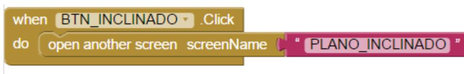
Essa montagem de blocos fornece a ação de quando clicar no botão (BTN\_INCLINADO) abrir a tela com o nome (PLANO\_INCLINADO).
