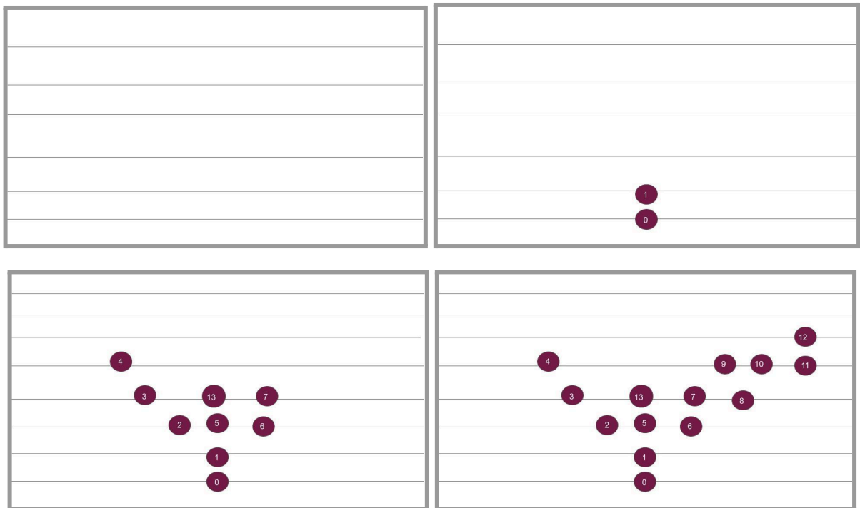
Figura 14: Evolução da construção do gráfico: passo 1, desenhar as linhas paralelas; passo 2 e 3 distribuir os cômodos em cada linha correspondente conforme suas conexões e; passo 4, ligar os pontos de baixo para cima, a partir dos espaços que se conectam. Fonte: Autoria pessoal.
