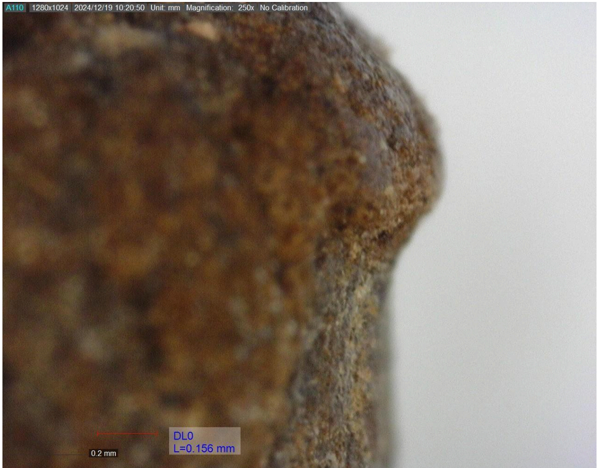
Figura 44: Marcas de desgaste localizado na extremidade da ponta.
