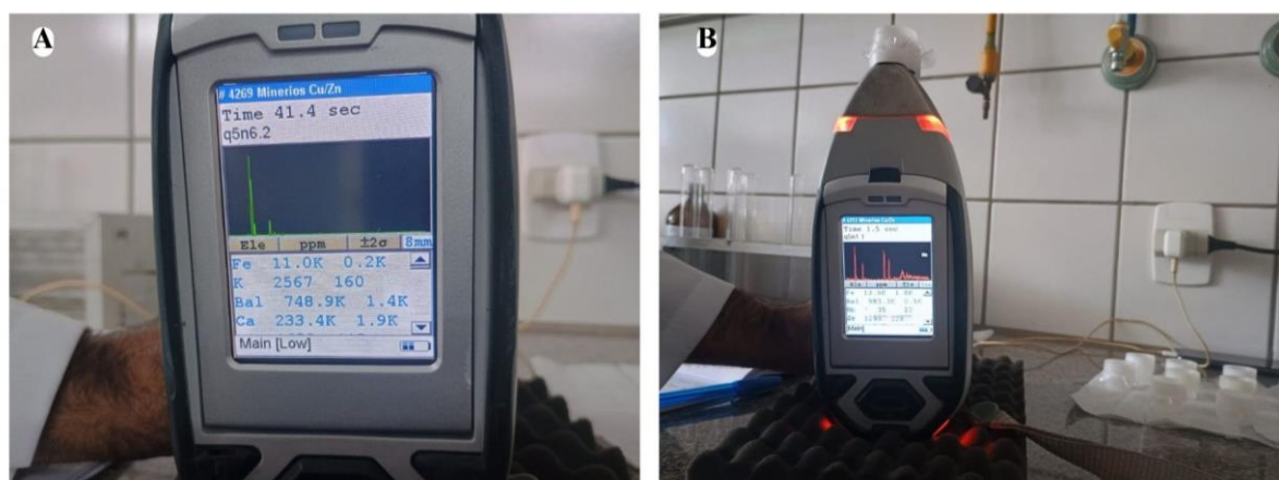
Figura 14 – Detalhes de uma medida experimental de determinação de composição química por fluorescência de raios X.
