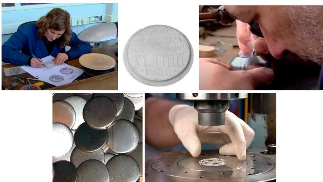
Figura 9 - Etapas do processo de criação de uma moeda por cunhagem mecânica: 1) Arte da moeda feita por um artista, 2) Cunho feito em escala maior em um molde de cera, 3) Inspeção e retoques finais no cunho, 4) Discos em "branco" prontos para ser cunhados, 5) Moeda recém-cunhada.
